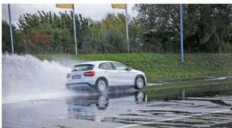
Ein Großteil der Trainingspisten wird mit sogenannten Gleitflächen versehen. Diese werden bewässert, um einen möglichen Reifenverschleiß zu verhindern und Bremsgeräusche zu minimieren. Auf den nassen Kunststoffbelägen können potenziell brenzlige Situationen wie ein wegrutschendes Fahrzeug oder eine Notbremsung auch im langsamen Geschwindigkeitsbereich erzeugt werden. Glatt wie eine festgefahrene Schneedecke bringen sie den Trainierenden schon bei etwa 30 Stundenkilometern ins Rutschen.
