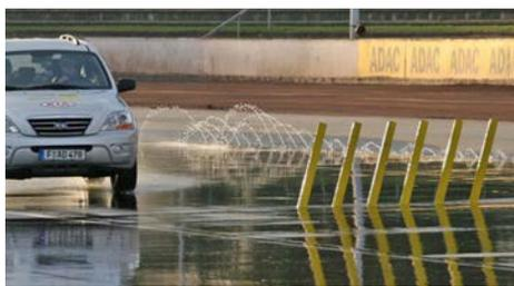
Ein Hindernis liegt auf der Fahrbahn und der Untergrund ist rutschig. Meist führt eine solche Situation zu einem panischen Bremsen oder einer Kollision mit dem Hindernis. Um das richtige Ausweichen und die korrekte Notbremsung absolut realitätsnah trainieren zu können, kommen auf dem Fahrsicherheitsplatz Ingolstadt sogenannte Klapphindernisse zum Einsatz.
